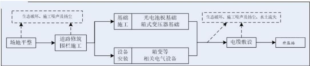
图 2-4 施工工艺流程污染节点示意图
