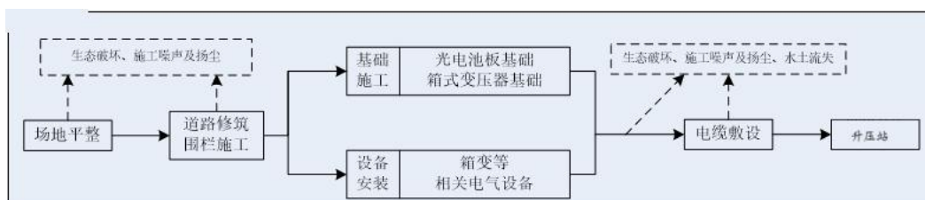
图 2-1 施工工艺流程污染节点示意图
