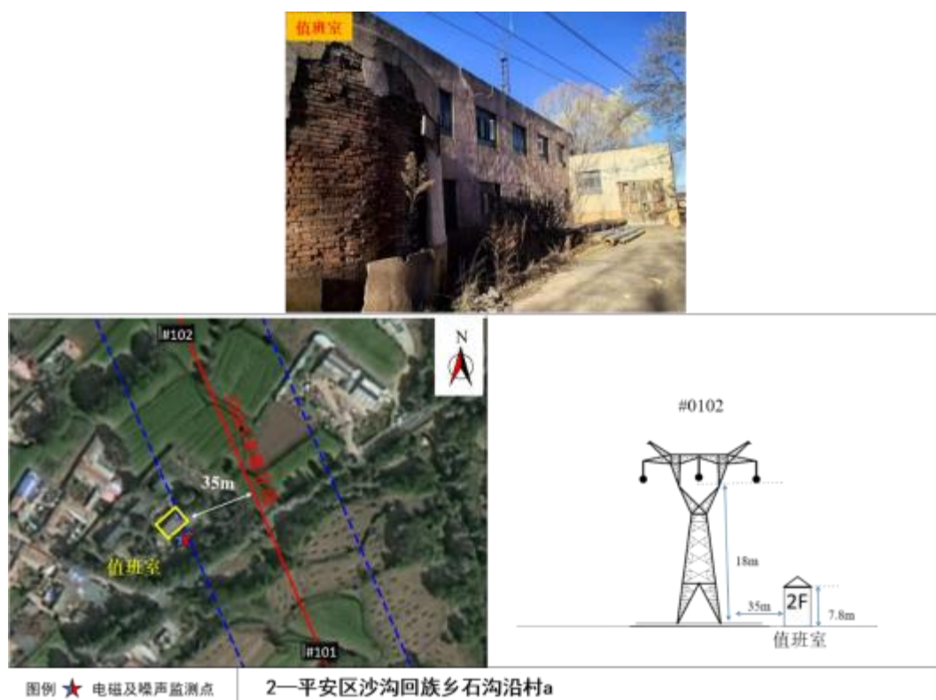
图 2-2 330kV 李曹 II 线与敏感点位置关系示意图：石沟沿村 a
