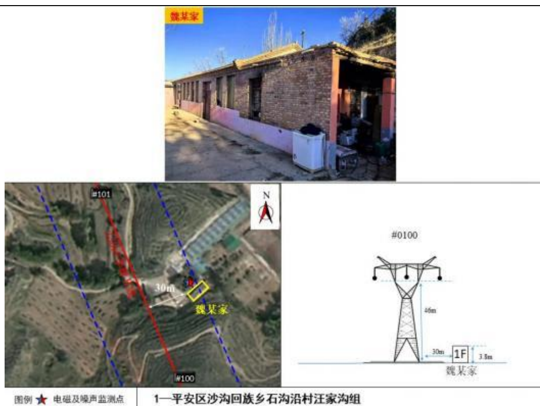
图 2-1 330kV 李曹 II 线与敏感点位置关系示意图：石沟沿村汪家沟组
