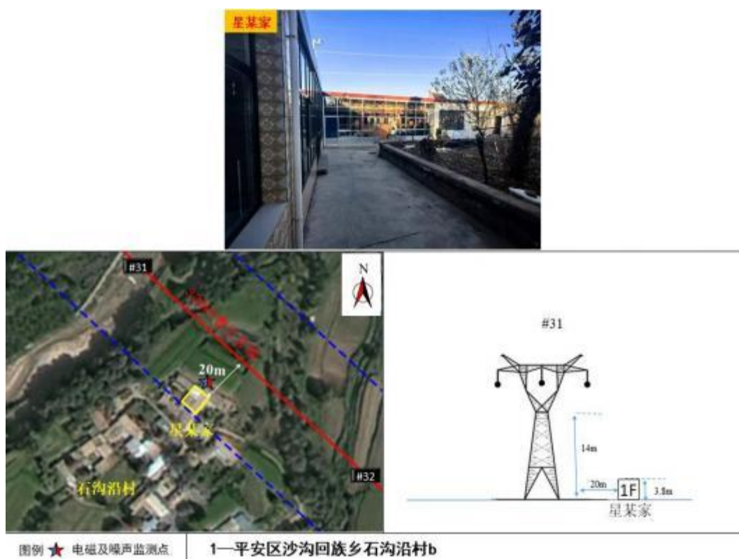
图 2-4 330kV 曹兰Ⅱ线与敏感点位置关系示意图：石沟沿村 b
